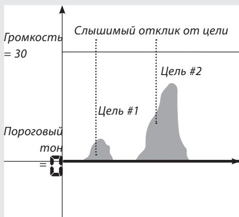
Если значение порогового тона установлено на 0, то звук порогового тона отключается и слышны только сигналы от целей
