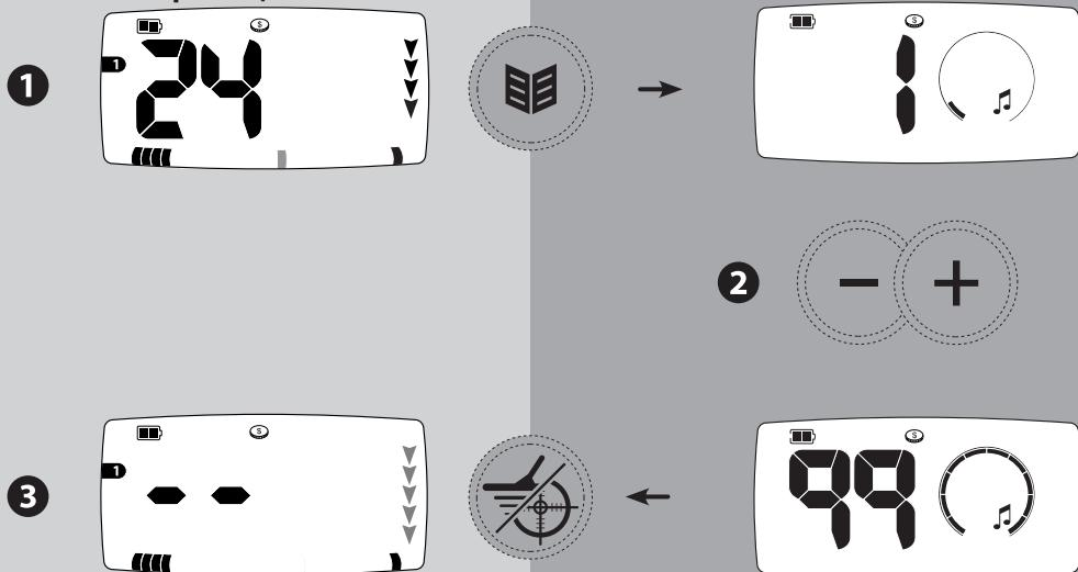
**Настройка частоты звука в режиме геологоразведки**
