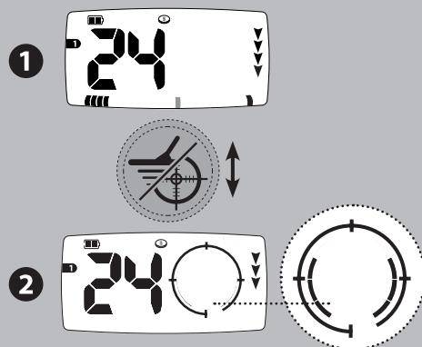
**!** Если Вы испытываете сложности с точным определением цели, нажмите кнопку Pinpoint/Detect. Чтобы вернуться в режим поиска, выйдите из зоны поиска и затем повторите действия 1-4.
