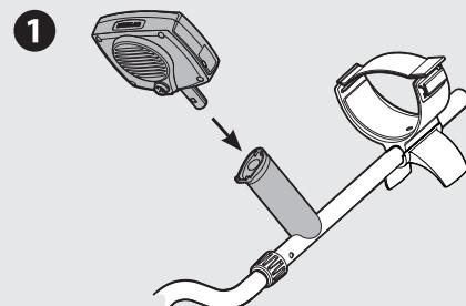
! Обязательно уберите шуруп перед отсоединением блока управления. В противном случае это может привести к повреждению детектора.
